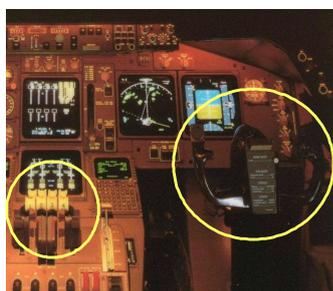
図4 ボーイング 747-400 のスラストレバーと操縦輪（写真提供：全日空）
