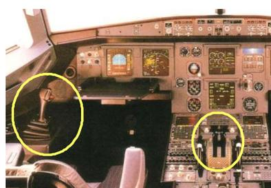
図5 エアバス A320 のサイドスティックとスラストレバー（写真提供：全日空）
