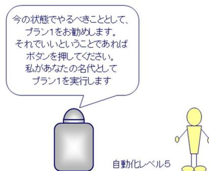
【例5】 TCAS が回避アドバイザリを提示したとき、「アドバイザリに従うのが適切だ」と判断したパイロットがボタンを押すと TCAS が回避操作を実行するという形態が実現できたとしましょう。そのような近未来型の TCAS の自動化レベルは5です。
