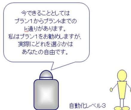
【例3】 異常をもたらしている可能性がある故障箇所候補のすべてを列挙するだけでなく、それらの候補のうち、異常の原因として最も可能性が高いのはどれであることを明示してくれる故障診断支援システムであれば、自動化レベルは 3 です。このときパイロットや中央制御室のオペレータは、「故障している可能性が最も高い箇所」として支援システムが提示しているところから調べていってもよいですが、「支援システムが提示しているものとは違う、別の故障箇所候補のほうがあやしいのではないか」という気がするのなら、そちらのほうを優先させてチェックしてもかまいません。支援システムが提供してくれる助言はあくまで参考情報ですので、最終的には自分の判断を優先させてよいのです。
