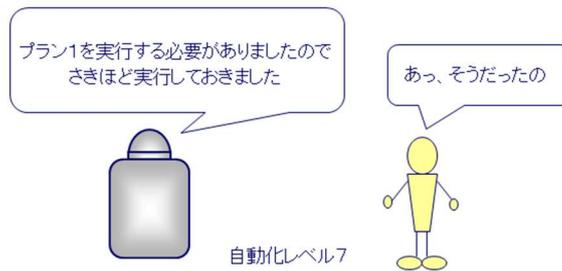
【例10】 先行車への衝突が予測されたとき、コンピュータが衝突を回避するための急ブレーキをかけるシステムとして最近実用化されたもののなかに、急ブレーキをかける時点ではドライバーに対して通告しないものがあります。もちろんドライバーは急ブレーキがかかったことは身体で感じることはできるでしょうが、このシステムでは、車が停止したときに「システムが自動緊急ブレーキをかけました」というメッセージがディスプレイに表示されます。このような事後報告方式のシステムの自動化レベルは7です。
