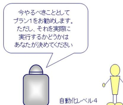
【例4】 航空機衝突防止装置 TCAS (traffic alert and collision avoidance system) は、このままの針路を保つと前方からの航空機に衝突するおそれがあると予測したとき、「上昇せよ」または「降下せよ」のいずれか一方を回避アドバイザリ RA (resolution advisory) としてパイロットに提示します。ただし、TCAS の指示に従うかどうかはパイロットの判断に委ねられています。もちろん、基本的には TCAS の回避アドバイザリは尊重することになっているのですが、「すでに低空を飛行しているのに、さらに降下するのは危い」というように「この場面での TCAS の指示は明らかにおかしい」とパイロットが判断したときは、回避アドバイザリに従わなくてもよいとされています。
