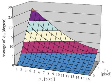
図 2 ガウス雑音パターンに対する、LPF の遮断周波数と局所領域の大きさ及びオプティカルフロー推定誤差の関係 ( $\sigma_n = 1$ )
