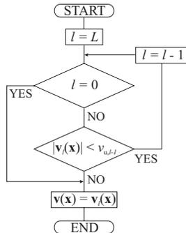
図 9 解像度レベルの選択法
