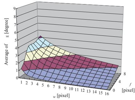
図 4 画像パターン A (上) 及び B (下) の時系列画像に対する、LPF の遮断周波数と局所領域の大きさ及びオプティカルフロー推定誤差の関係
