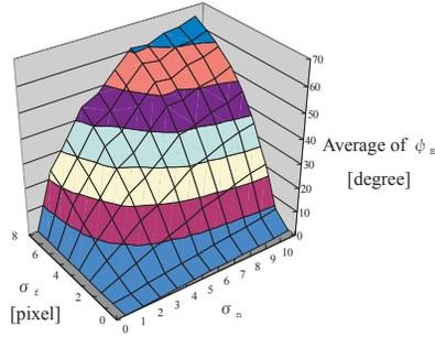
図 1 ガウス雑音パターンの時系列画像に対する、雑音の強さと LPF の遮断周波数及びオプティカルフロー推定誤差の関係 ( $\sigma_w = 2$ )
